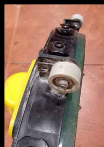
Zużyte koło podporowe ssawy
