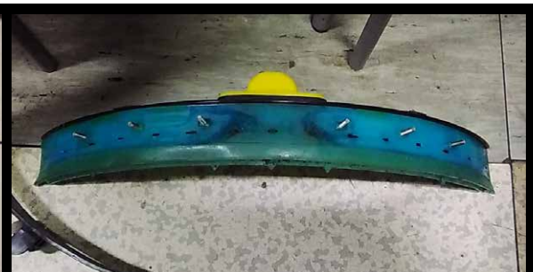
Zniszczone krawędzie, zeszywniałe od chemii i zbyt długiego używania
